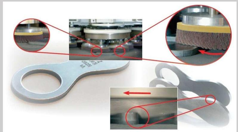
Entgraten und allseitige Kantenverrundung von gebrannten, gelaserten und gestanzten Blechteilen unterschiedlicher Materialqualitäten im Trocken- oder Nassverfahren. Die Vliesschleifteller sind gruppenweise auf den Planetenköpfen zusammengefasst. Sie drehen sich um sich selbst und rotieren gleichzeitig um das Sonnenrad wodurch eine optimale Bearbeitung an allen Kanten gewährleistet ist.
